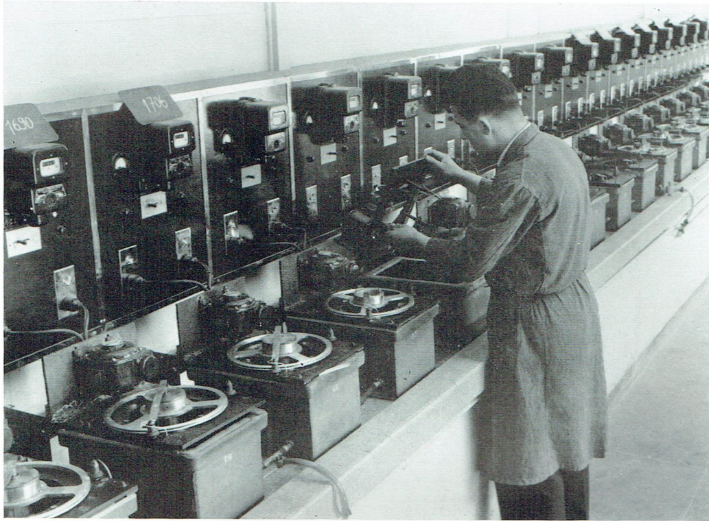
Les cuves à électrolyse utilisées pour la fabrication des rotors spéciaux des moteurs CAMECA.
