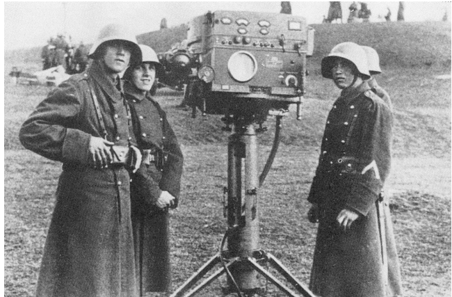
Durch die Schweiz ab 1937 angeschafft und bei HASLER in Lizenz gebaut: Ungarisches Kommandogerät GAMMA-JUHASZ. Links die beiden Fernrohre zur Verfolgung des Fliegers.
