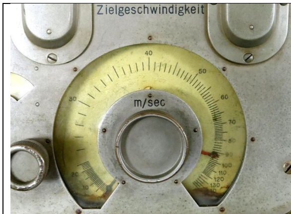
Anzeige des Geschwindigkeitsmessers, Skala in m/s. Die relevanten Werte sind alle rechts zusammengedrückt. Ein schwarzer (System I, von Hand) und ein roter (System II, automat.) Zeiger sind sichtbar – beim Einschalten des Gerätes werden sie erst auf die richtige Position springen. Ausführung 1938.
